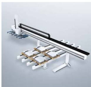
SortMaster: ergonomiczne sortowanie, większe możliwości rozładunku.
