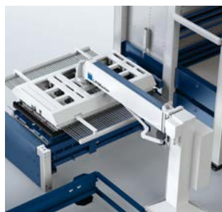
Łatwy załadunek i rozładunek palet pomocniczych przy pomocy LiftMaster.
