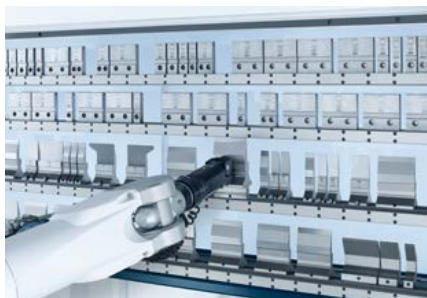
Urządzenie ToolMaster Bend automatycznie przezbiera narzędzia.
