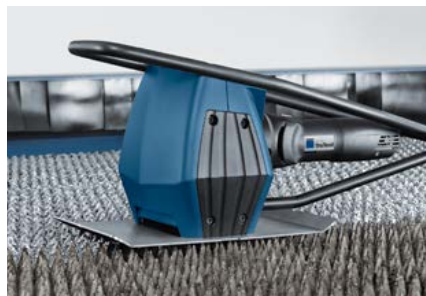
Urządzenie TruTool TSC 100 pracuje automatycznie ze stacją sortowania oraz czyszczenia listew.
