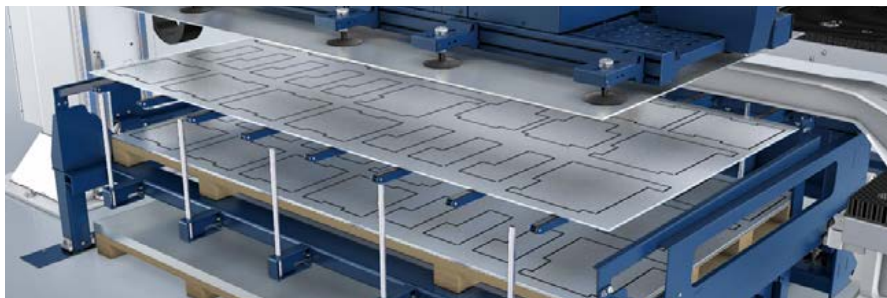
Bezpieczne odkładanie arkuszyz mikropołączeniami dzięki grzebieniom taśmowym.
