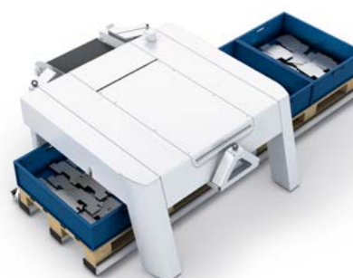
SortMaster Box Linear: łatwe, sortowanie bez zadrapań do pojemników poruszających się liniowo.
