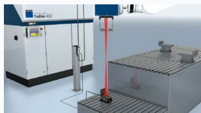
CalibrationLine mierzy moc lasera i w razie potrzeby automatycznie reguluje odchylenia.
