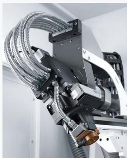
Optyka robocza BEO D70 z osią uchylną zintegrowana w TruLaser Station 5005.
