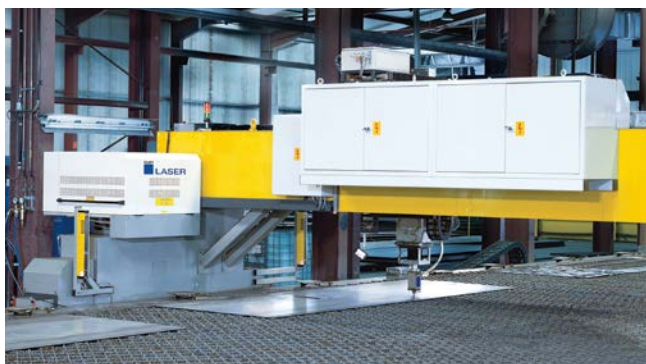
Stabilny rezonator może być zainstalowany nawet na ruchomych suwnicach.
