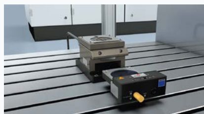
Czujnik do pomiaru mocy lasera.
