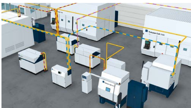
Laser TruDisk zaopatruje w sieci aż do 6 maszyn.
