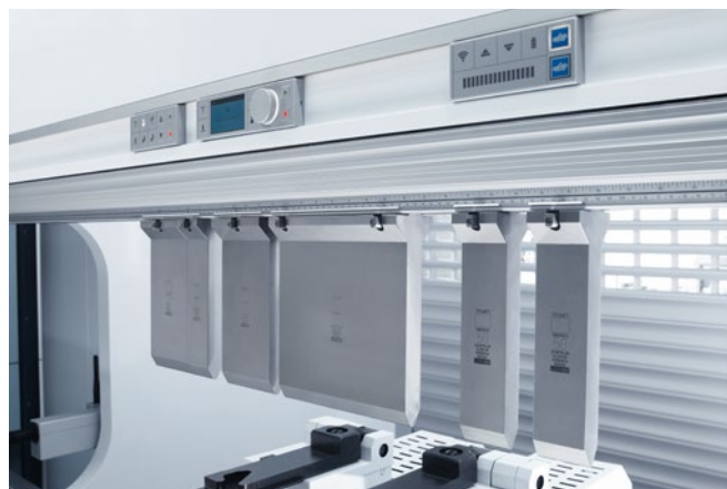
Podczas przebrajania Tool Indicator dokładnie wskazuje, gdzie muszą zostać użyte narzędzia do gięcia
