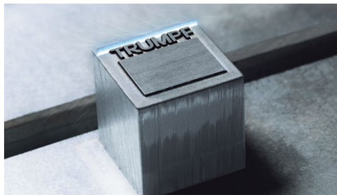
Głębokie grawerowanie z wykorzystaniem wysokiej mocy oraz krótkiego czasu cyklu.
