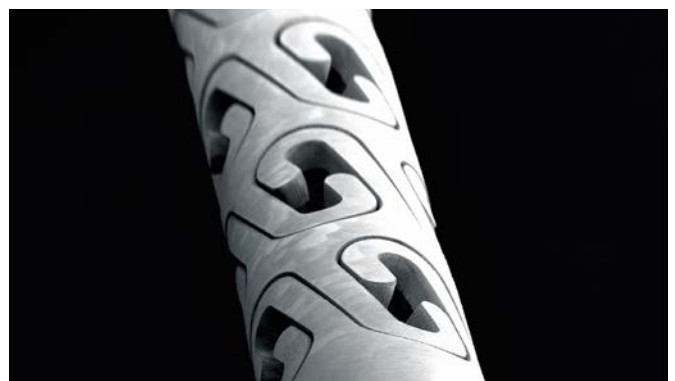
Powierzchnie i krawędzie cięte laserowo bez gradu
