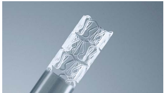
Lasery o ultrakrótkich impulsach umożliwiają produkcję stentów z podatnych na ciepło polimerów
