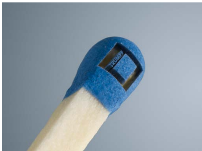
Obróbka na zimno przy pomocy pikosekundowych impulsów na główce zapałki
